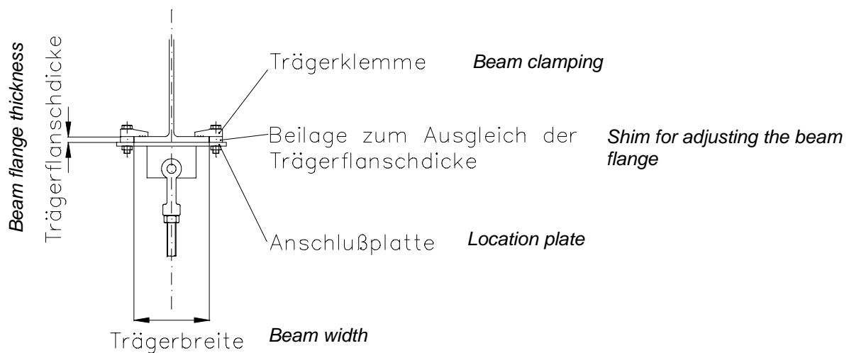
Abb. 5 : Trägerklemmbefestigung mit erforderlichen Abmessungen und Bauteilen
